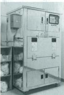
ソリューションウォーターの 製造機械、次亜塩素酸ソーダ希釈・ pH調整装置
