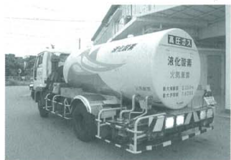
酸素を運搬するタンクローリー車
